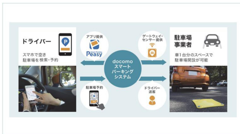
図1 車両感知センサを活用した簡易駐車場開設イメージ
