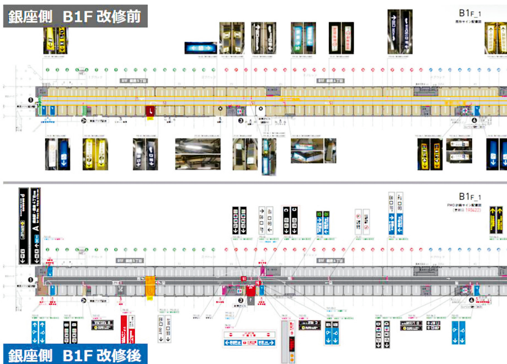
駐車場サインのマップ化(銀座側B1F)上が改修前、下が改修後
