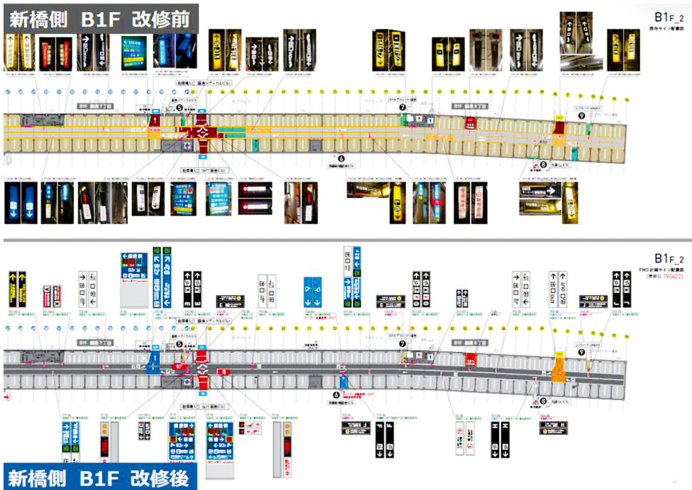
駐車場サインのマップ化(新橋側B1F)上が改修前、下が改修後
