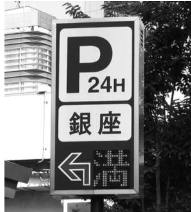
路外駐車場案内標識 (内照式・駐車場名入り・満空表示付き)
